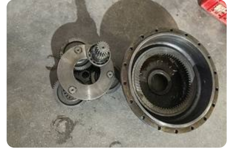
Kontrol için açılan planet kademesi
